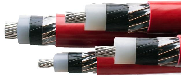
Cable monoconductor formado por un conductor de cobre suave o aluminio duro 1 350, pantalla semiconductora sobre el conductor, aislamiento de polietileno de cadena cruzada (XLPE),
